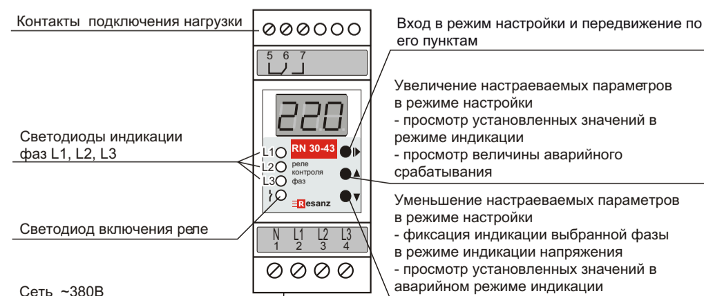
Рис. 1: устройство прибора
