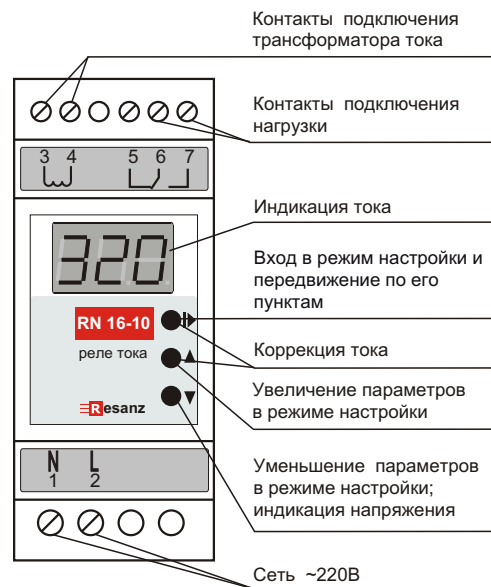
Рис. 1: устройство прибора
