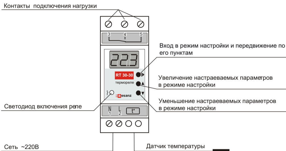
Рис. 1: устройство прибора
