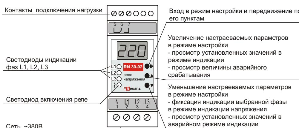
Рис. 1: устройство прибора
