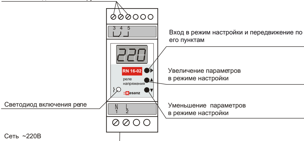
Рис. 1: устройство прибора
