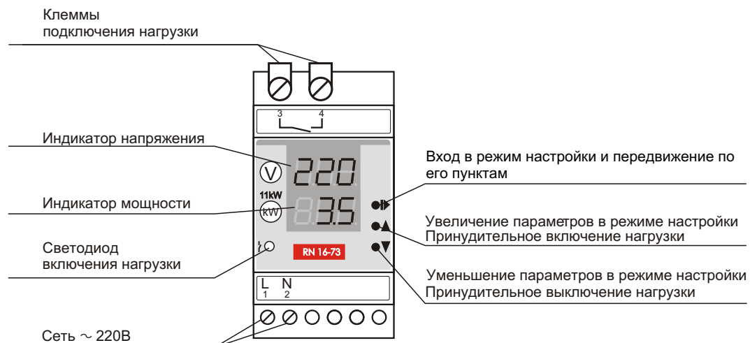
Рис. 1. Устройство прибора
