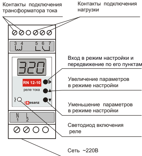
Рис. 1: устройство прибора
