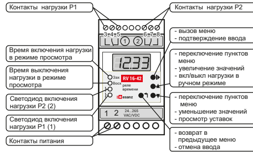
Рис. 1: устройство прибора
