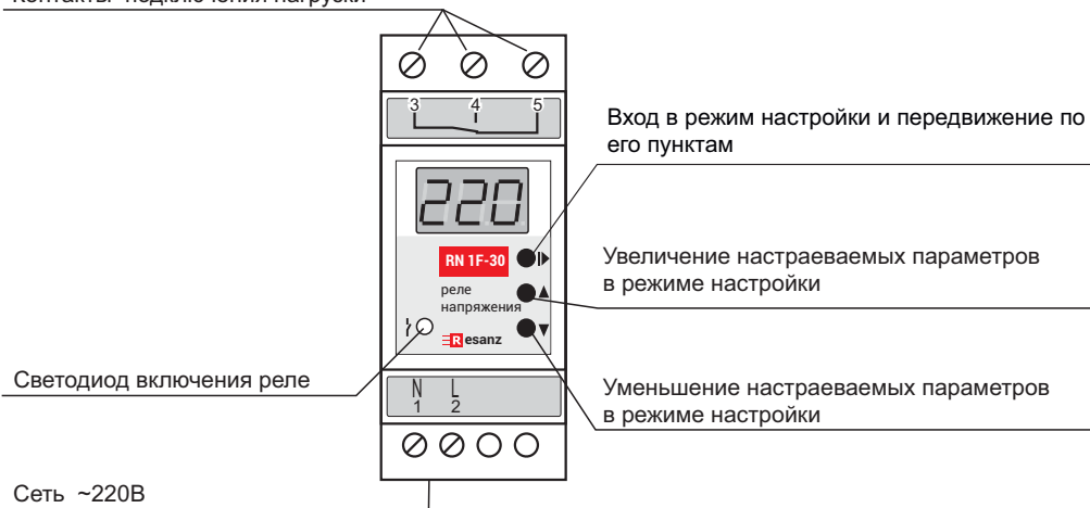
Рис. 1: устройство прибора
