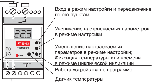
Рис. 1: устройство прибора
