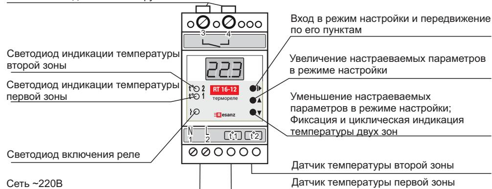
Рис. 1: устройство прибора
