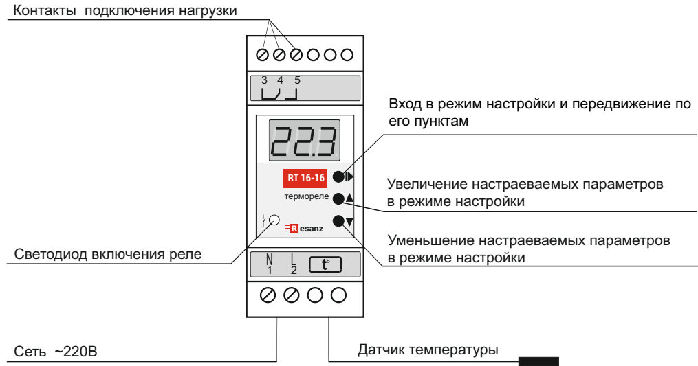
Рис. 1: устройство прибора
