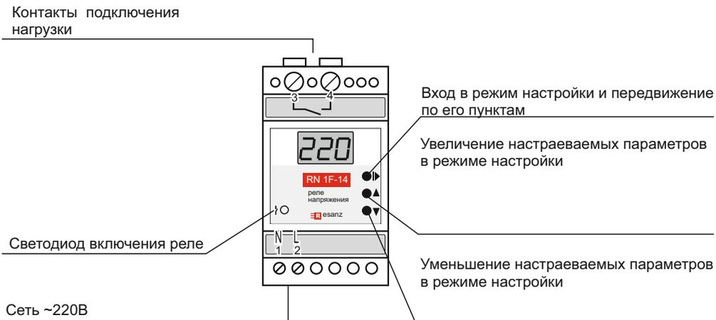
Рис. 1: устройство прибора
