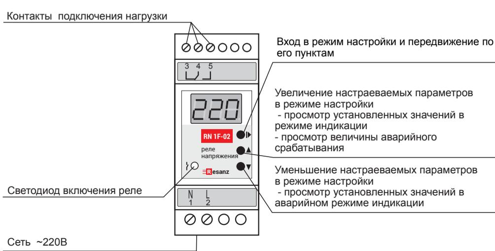
Рис. 1: устройство прибора
