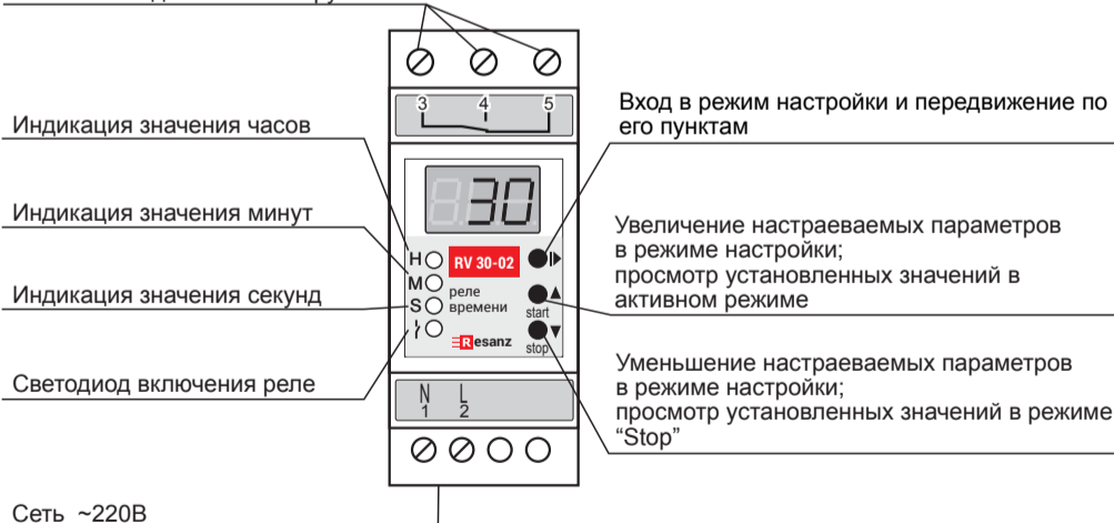
Рис. 1: устройство прибора
