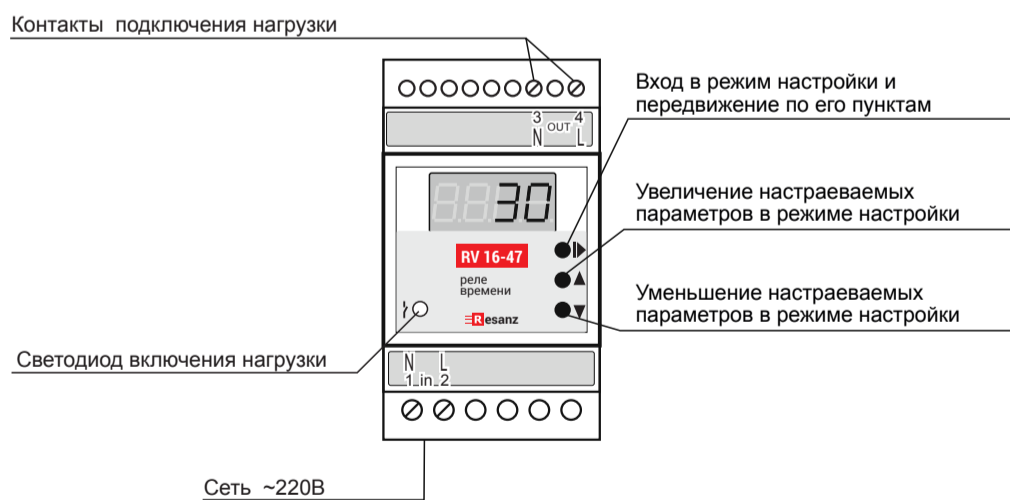
Рис. 1: устройство прибора
