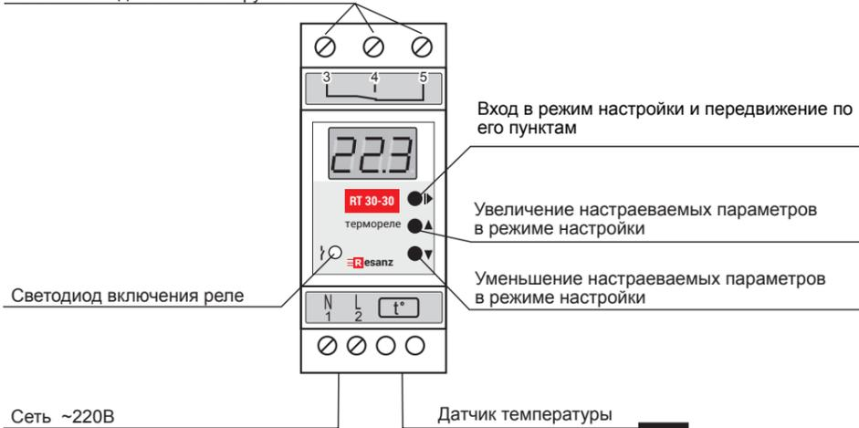
Рис. 1: устройство прибора
